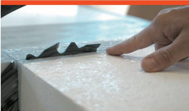
COMPACFOAM lässt sich problemlos mit handelsüblichen Sägen wie Kreissägen, Druckbalkensägen oder Handkreissägen zuschneiden. Wichtig ist dabei die Verwendung von Sägeblättern mit großem Zahnabstand und freiem Spanraum.
